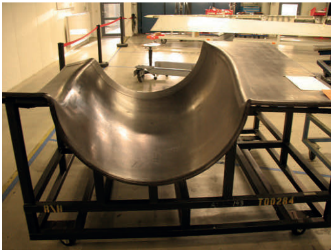
Bild 6.7 CFK-Tooling aus Gewebe-Prepreg [Bildquelle: Lufthansa Technik GmbH]
