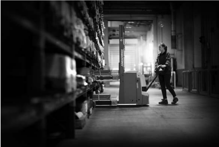
Bild 6.7 Gabelhochhubwagen im Einsatz (Quelle: Jungheinrich AG)
