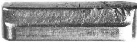
Bild 1.7 Passfeder mit Verschleißerscheinung
