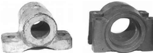
Bild 1.8 Lagerböcke. Links ausgeprägte Fußflansche, Biegung wird durch Wanddicke beherrscht (Baujahr 1920); rechts zweckmäßige Gestalt (auch für abhebende Beanspruchung geeignet)
