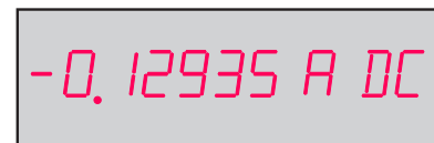
Bild 1.8 Schaltzeichen Amperemeter mit Klemmenbezeichnungen für eine Gleichstrommessung und Anzeige eines digitalen Multimeters in der Betriebsart Strommessung; die Buchstaben DC bedeuten direct component (Gleichgröße).
