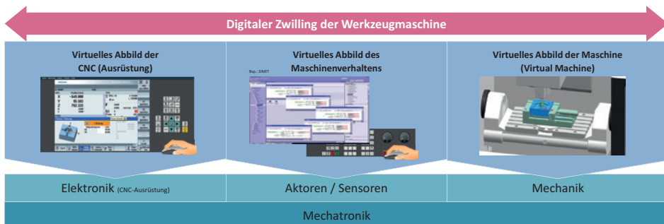
Bild 5.15: Der Digitale Zwilling verbindet die virtuellen Abbildungen der Elektronik, Sensorik und Mechanik einer Werkzeugmaschine.
