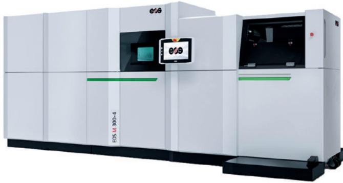
Bild 2.15: Maschine für digital additive Fertigung für die industrielle Produktion von hochwertigen Metallteilen. Der nebenstehende QR-Code verlinkt auf ein Video, das den Druckprozess zeigt.
