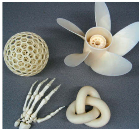
Bild 2.19: Verschiedene Bauteile – erstellt mit FDM.
