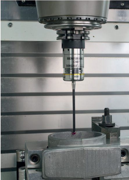
Bild 3.3: Durch Vierpunktmessung einer Bohrung wird der Werkstücknullpunkt in die Mitte des Rohteils gelegt.
