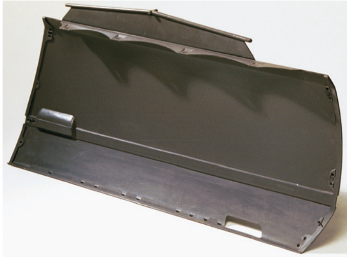
Bild 4.14 Kfz-Karosserieelement, das mit einem speziellen Bandanschnitt hergestellt wird, um Binde- nähte zu vermeiden und die Gefahr von Eigenspannungen und Verzug zu minimieren
