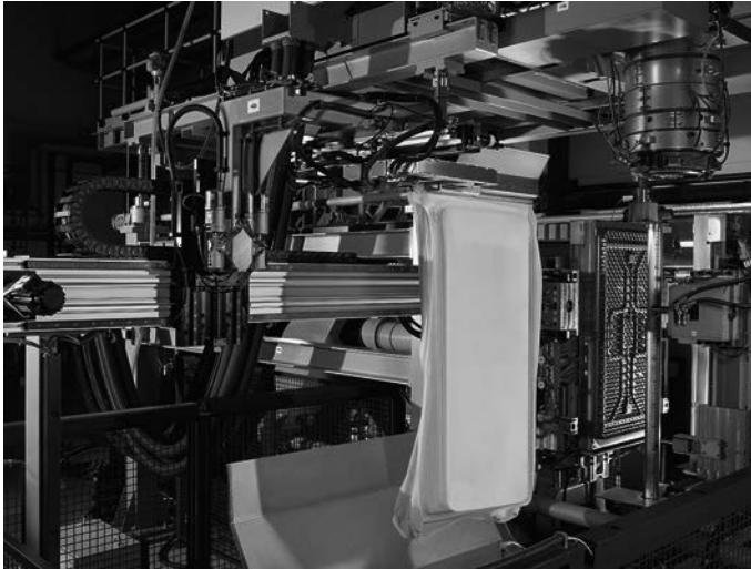
Bild 1.9 Extrusionsblasgeformtes flaches Panel (Tischplatte) (Bild: Kautex Maschinenbau)
