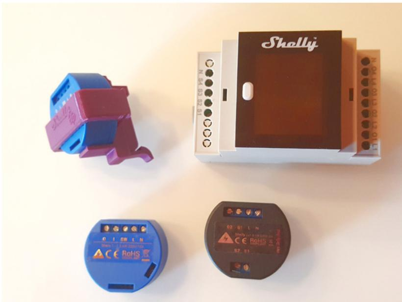
**Bild 3.2** Schaltaktoren von Allterco Robotics (von links: Shelly 1 in einer Hutschienhalterung, Shelly 1, Shelly 4 Pro, Shelly 2)
