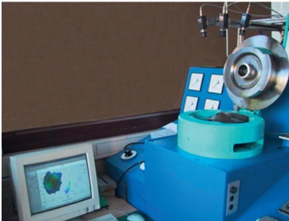
ERICHSEN – Prüfgerät mit VIALUX – Messkopf und Rechentechnik zur Aufnahme von Grenzformänderungsdiagrammen
