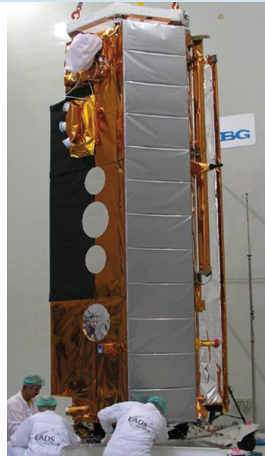
Bild 1.2.12: Der TerraSAR-X-Satellit beim Abnahmetest vor dem Transport zum Startplatz. Die Nutzlast (X-Band-Radar) ist in den Hauptkörper des Satelliten integriert. Die Kommunikation erfolgt über eine Auslegerantenne, die rechts an der Seite im eingeklappten Zustand erkennbar ist (Bild: DLR).
