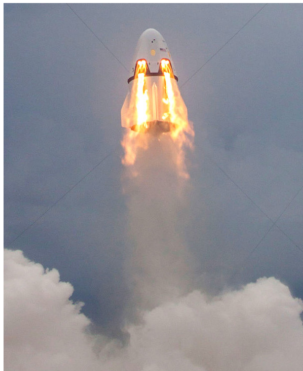
Bild 1.1.35: Erster Flugtest (Pad Abort Test) des Sicherheitssystem der Dragon V2 Kapsel im Mai 2015 (Bild: SpaceX)
