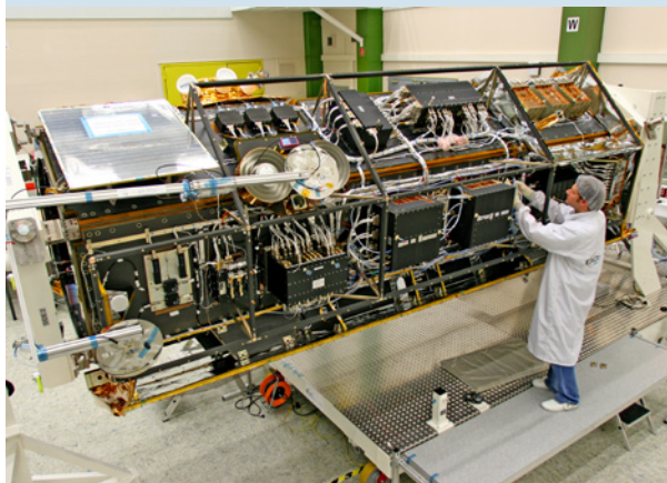
Bild 1.1.20: Der im Jahr 2007 gestartete Satellit TerraSAR-X wird durch den 2010 gestarteten nahezu baugleichen Satelliten TanDEM-X ergänzt, der hier im Integrationsraum abgebildet ist. So können in der Konstellation der beiden Satelliten hochaufgelöste Höhenprofile weltweit ermittelt werden (Bild: DLR. Siehe auch Bild 1.3).
