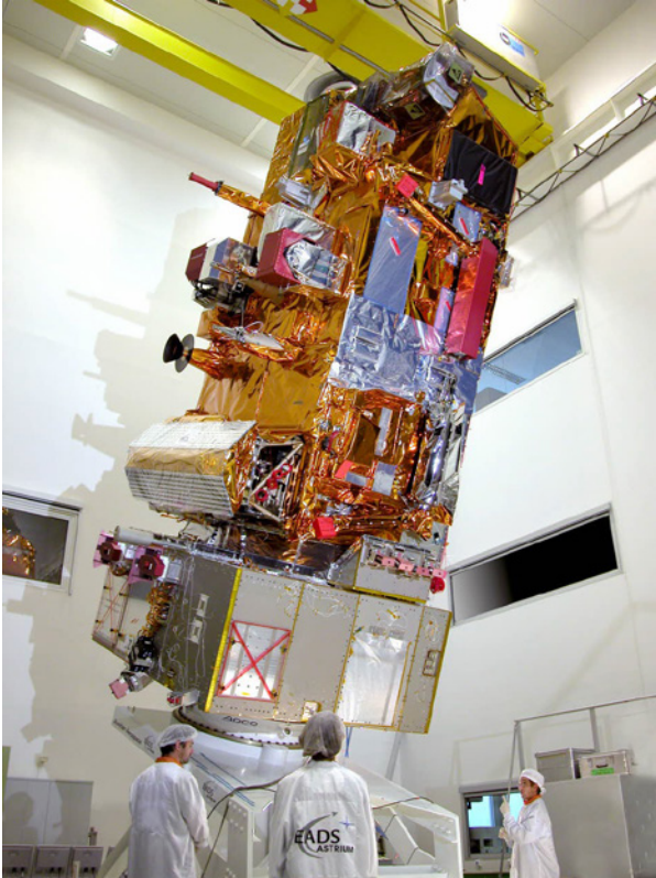
Bild 1.2.13: Auch der europäische MetOp-A-Satellit fliegt in einer sonnensynchronen und niedrigen Erdumlaufbahn. Er wird im Verbund mit einem amerikanischen NOAA-Wetterbeobachtungssatelliten eingesetzt. Dies dient zur optimierten Abdeckung der relevanten Beobachtungsbereiche (Bild: ESA).
