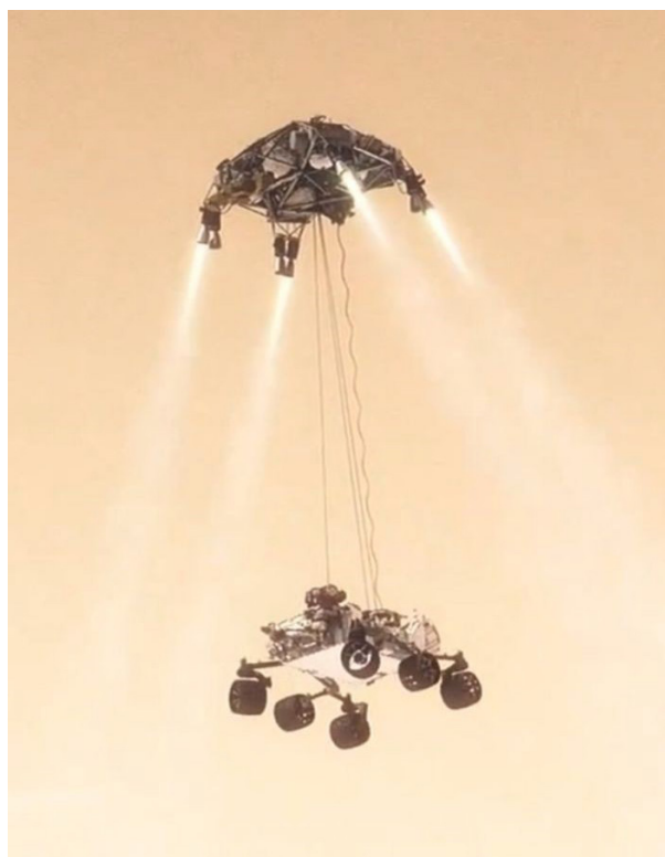
Bild 7.4.19: Curiosity-Landeszenario mit „Sky-Crane“ (Bild: NASA/JPL).
