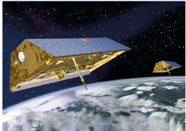
Bild 1.1.19: Die mit einem Abstand von ca. 200 km fliegenden Satelliten werden zur hochgenauen Vermessung des Schwerefelds der Erde genutzt. Dies wird durch die Bestimmung von Variationen im Abstand der beiden Satelliten im Mikrometerbereich erreicht. Träger: Rokot (Bild: Astrium/DLR).
