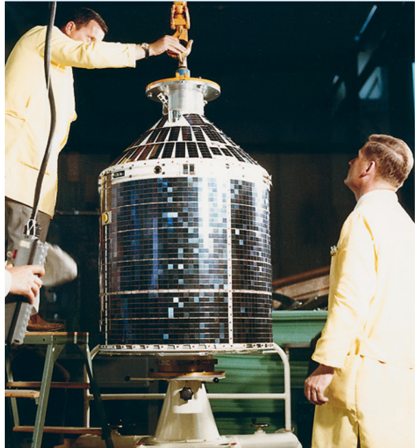
Bild 1.1.6: AZUR diente der Erforschung der Strahlungsgürtel der Erde unter Systemführung der Bölkow GmbH. Der Satellit wurde von einer amerikanischen Scout-Rakete auf eine polare Umlaufbahn gebracht. Eine Besonderheit war, dass alle eingesetzten Materialien unmagnetisch sein mussten (Bild: DLR).
