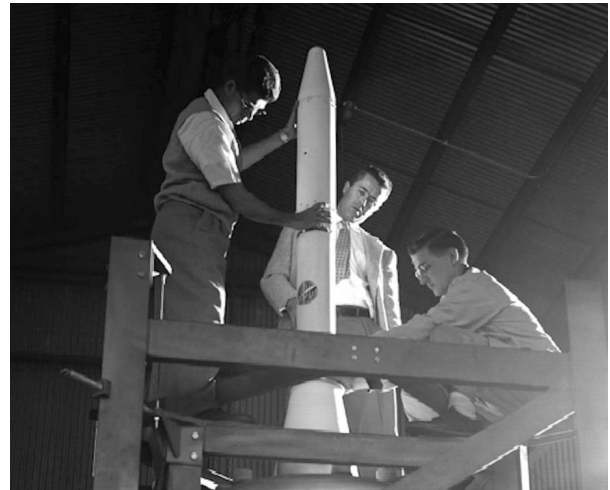
Bild 1.2: Im Jahr 1957 fand die Qualifizierung des Satelliten Explorer 1 für den Flug statt, für die hier Ingenieure des Jet Propulsion Laboratory einen Test vorbereiten. Explorer 1 war der erste Satellit mit wissenschaftlichen Messinstrumenten. Bei seiner Mission im Januar 1958 wurden Daten gewonnen, die auf einen Strahlungsgürtel um die Erde hindeuteten. Später wurde der Strahlungsgürtel nach James van Allen, dem wissenschaftlichen Betreuer der Mission, benannt. (Bild: NASA)
