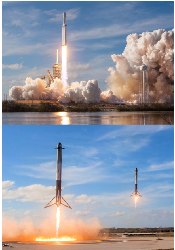
Bild 1.1.5: Testflug der Falcon Heavy Rakete. Der obere Teil zeigt den Start der Rakete, der untere die Landung der zwei äußeren Booster 8 Minuten nach dem Start am Cape Canaveral (Bild: SpaceX).
