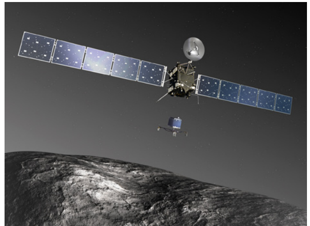
Bild 1.4: Bei der Rosetta Mission der ESA gelang es erstmals, aus dem Orbit um einen Kometenkern ein umfassendes Mess- und Beobachtungsprogramm durchzuführen und mit dem Landegerät Philae die Oberfläche des Kernes zu charakterisieren. (Bild: ESA)
