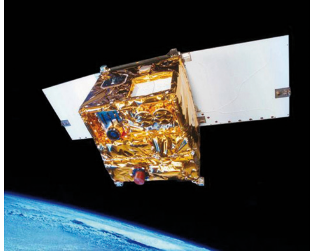
Bild 1.1.18: Mit dem DLR-Satelliten BIRD konnten zahlreiche neue Satellitenkomponenten erprobt werden. So lieferten die Infrarotkameras hervorragende Daten zur Detektion und Untersuchung von Bränden, vulkanischer Aktivität und thermalen Besonderheiten der Erdoberfläche. Der Start erfolgte mit einer indischen PSLV-Rakete (Bild: DLR). Auf Grundlage der Bird Technik wurden die Satelliten TET (Start 2012) und Biros (Start 2016) entwickelt (siehe große Abbildung vor Kapitel 2)
