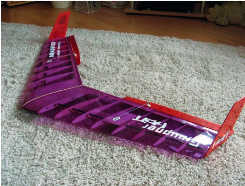
**Bild 8.23** Der Balsa-Zagi ist ein schönes Beispiel für ein Flugzeugmodell in Spantenbauweise (© Michael Haase, rc-network.de).
