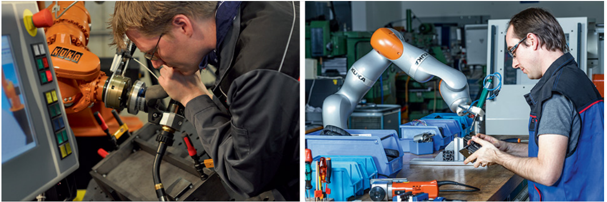
Bild 1.4 Links: Handgeführte Steuerung eines Industrieroboters durch direkte Bewegungsvorgabe (Quelle: Fraunhofer IPA); rechts: der LBR als dritte Hand des Mitarbeiters (Quelle: Fraunhofer IPA)
