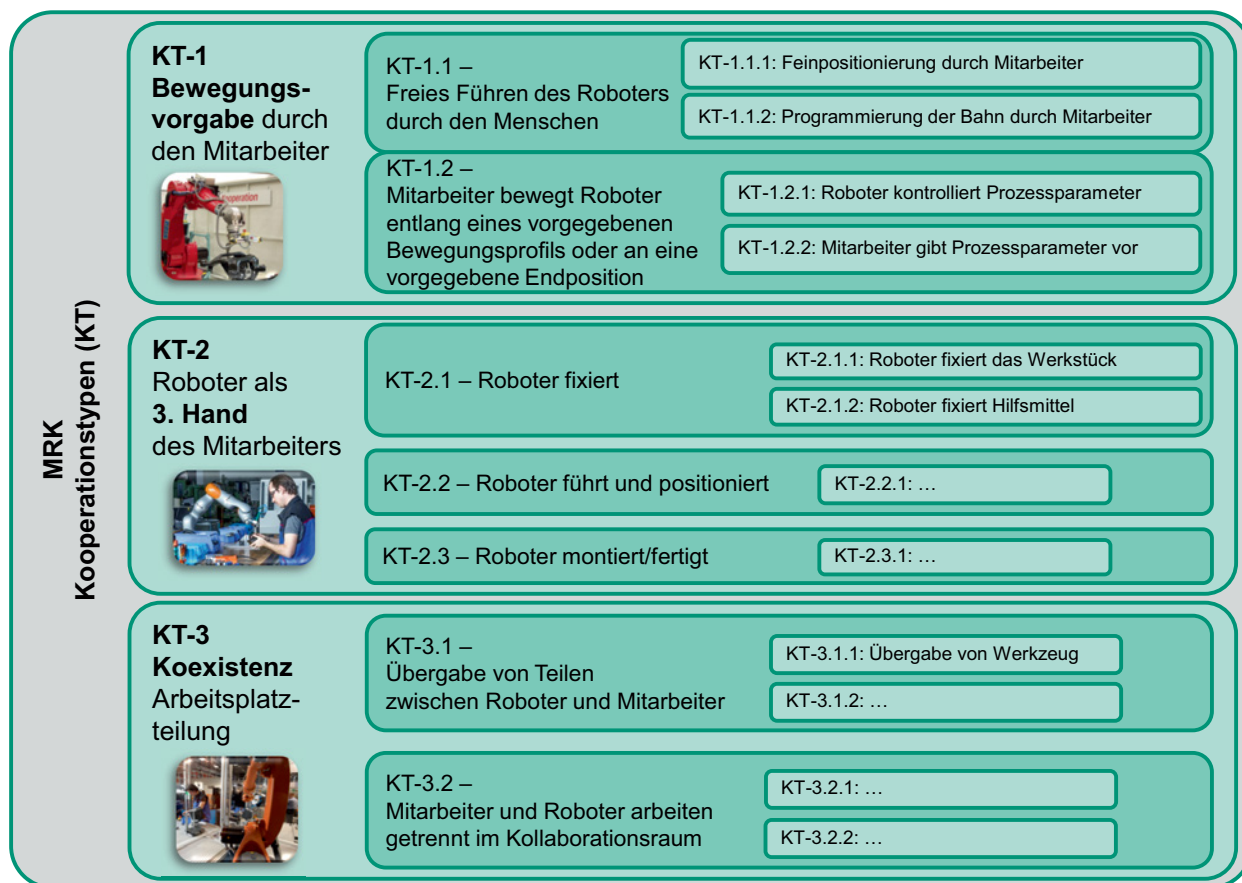
Bild 1.3 MRK-Taxonomie zur Auswahl und Bewertung von MRK-Kooperationstypen in einer Anwendung (Dietz, Oberer-Treitz 2015)
