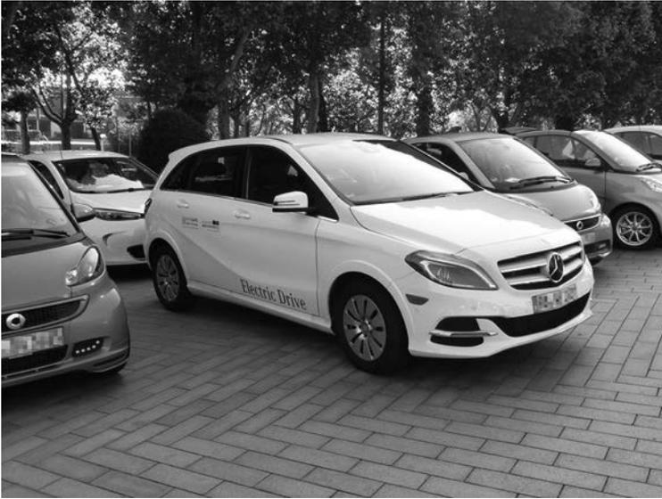
**Bild 2.5** Beispiel für Conversion Design: Daimler B-Klasse Electric Drive
