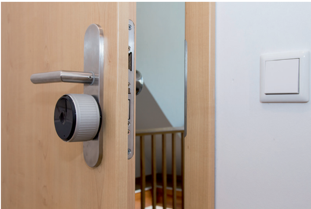
Bild 2.9 Ein elektrisches Türschloss ermöglicht automatisches Ver- und Entriegeln der Tür (© Chris Bertko).
