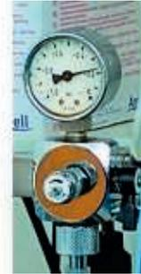
**Abb. 1.9** Sog überprüfen und ggf. reduzieren.
