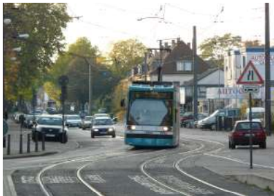
Bild 2.1 Wirkung der Fliehkraft im Kreisbogen ohne Überhöhung
