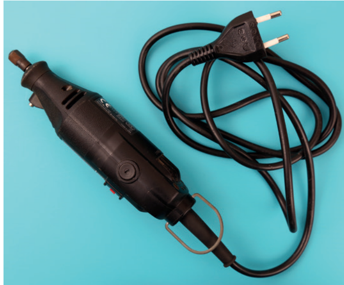
Bild 5.16 Alt gedienter Feinschleifer eines Kollegen mit direkter 230 V-AC-Versorgung
