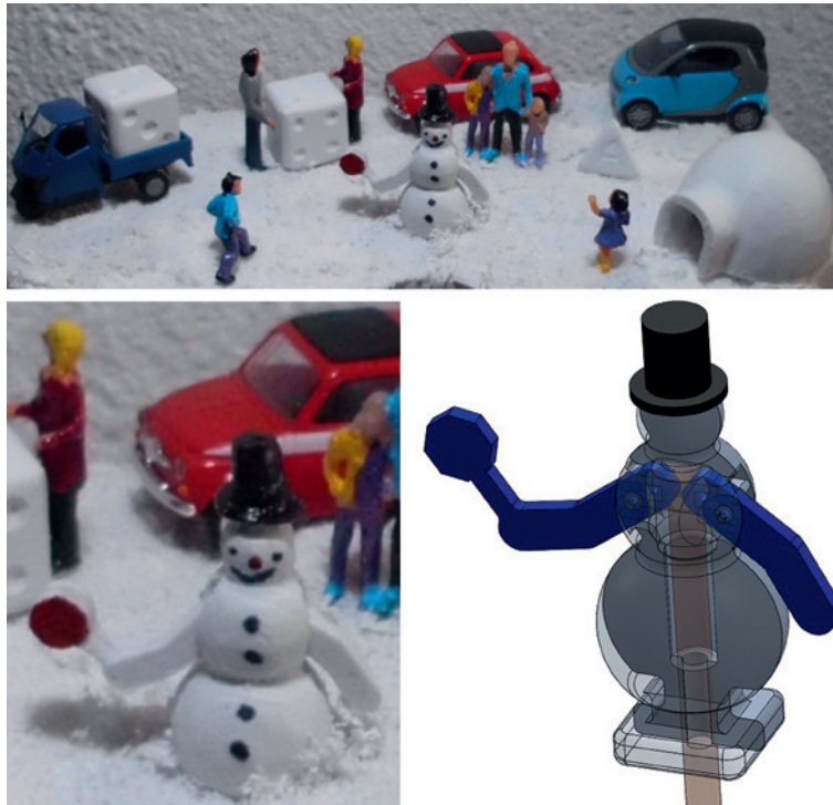
Bild 1.5 Diorama mit Schneemann im Maßstab 1:87; 3D-Modell des aus mehreren Teilen bestehenden Schneemanns
