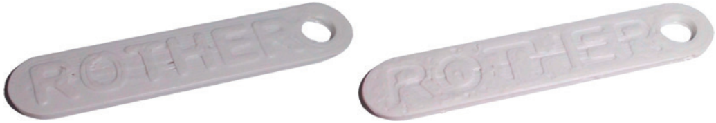
Bild 7.24 3D-gedruckter Schlüsselanhänger mit Konturkanten (links: erhabene Kontur der Buchstaben, rechts: versenkte Kontur der Buchstaben)
