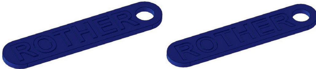
Bild 7.22 CAD-Konstruktion des Schlüsselanhängers mit Konturkanten (links: erhabene Kontur der Buchstaben, rechts: versenkte Kontur der Buchstaben)
