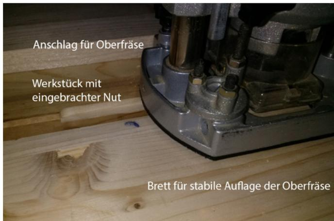
**Bild 5.7** Einbringen einer Stufe mit der Oberfräse
