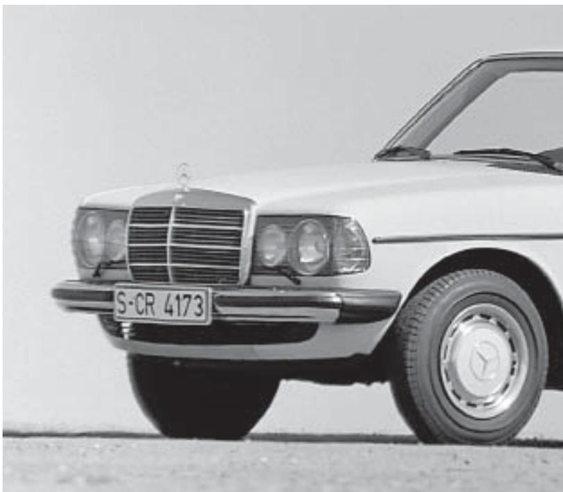
*Bis auf die 280er trugen alle Modelle diese von Schutzecken aus Kunststoff flankierten Bugstoßfänger.*
