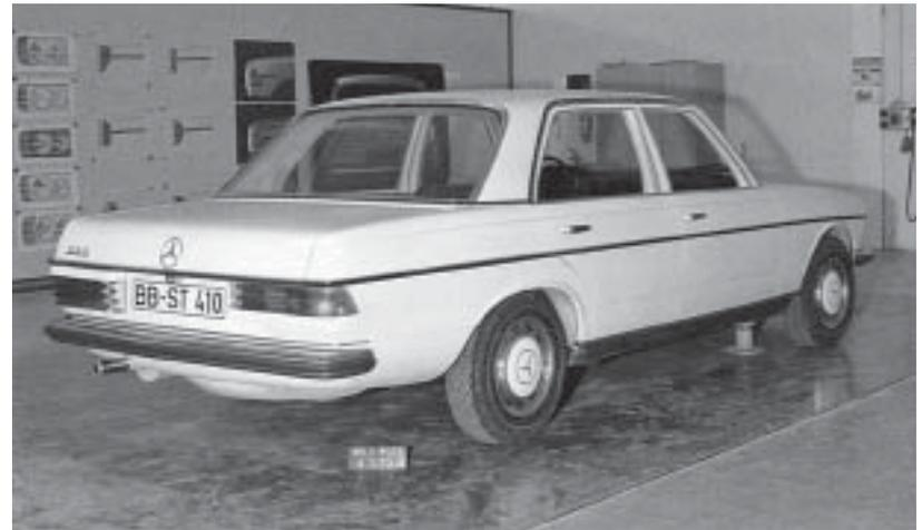
An einem sonst schon sehr fertig wirkenden Modell wurden im Januar 1973 noch verschiedene Rückleuchtenformen getestet. Die Schautafeln im Hintergrund zeigen, wie auch an der Frontpartie mit diversen Scheinwerfer/Blinker-Kombinationen experimentiert wurde.
