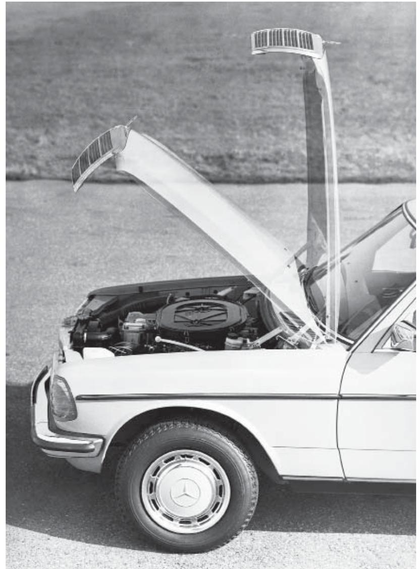
*Die Motorhaube ließ sich für Reparaturen oder routinemäßige Servicearbeiten auf Hebeldruck senkrecht stellen.*
