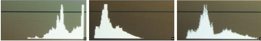
Abbildung 21: Verschiedene Live-Histogramme desselben Motivs mit Tendenz zu Überbelichtung (links) und Unterbelichtung (mitte). Rechts zum Vergleich ein ausgeglichenes Histogramm.
