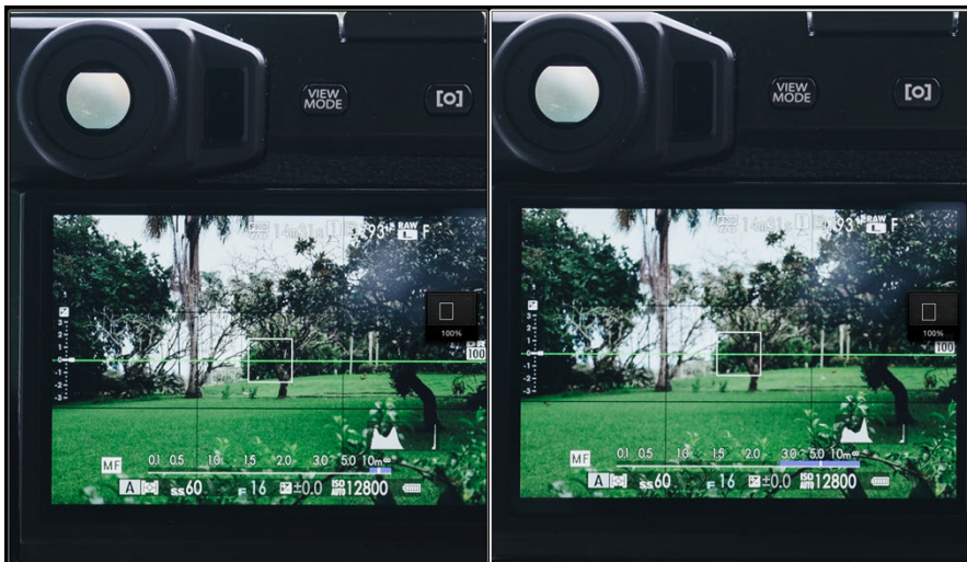
Abbildung 37: Einstellen der hyperfokalen Distanz mithilfe der elektronischen Schärfentiefe-Skala: Anstatt direkt auf eine bestimmte Entfernung zu fokussieren, wird der Schärfentiefe-Balken so eingestellt, dass er rechts gerade an \infty anstößt. Auf diese Weise ergibt sich die hyperfokale Distanz mit der für die jeweils eingestellte Blende größtmöglichen Schärfentiefe. Die Abbildung zeigt die hyperfokale Distanz für ein XF35mmF2-Objektiv bei Blende 16, jeweils mit den Einstellungen PIXEL-BASIS (links) und FILMFORMAT-BASIS (rechts).
