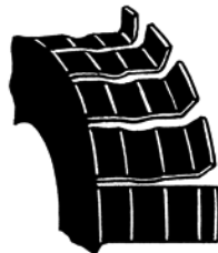
Bild 8.2.63 Geschlitzter Federkorb zum Toleranzausgleich der Gehäusebohrung
