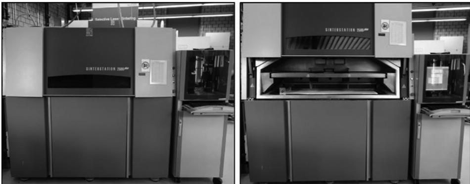
**Bild 2.2** DTM SinterStation 2500plus (Baujahr 1999); links: geschlossen; rechts: offen, mit Blick in den Baubereich (Prozesskammer) [Quelle: Inspire AG]
