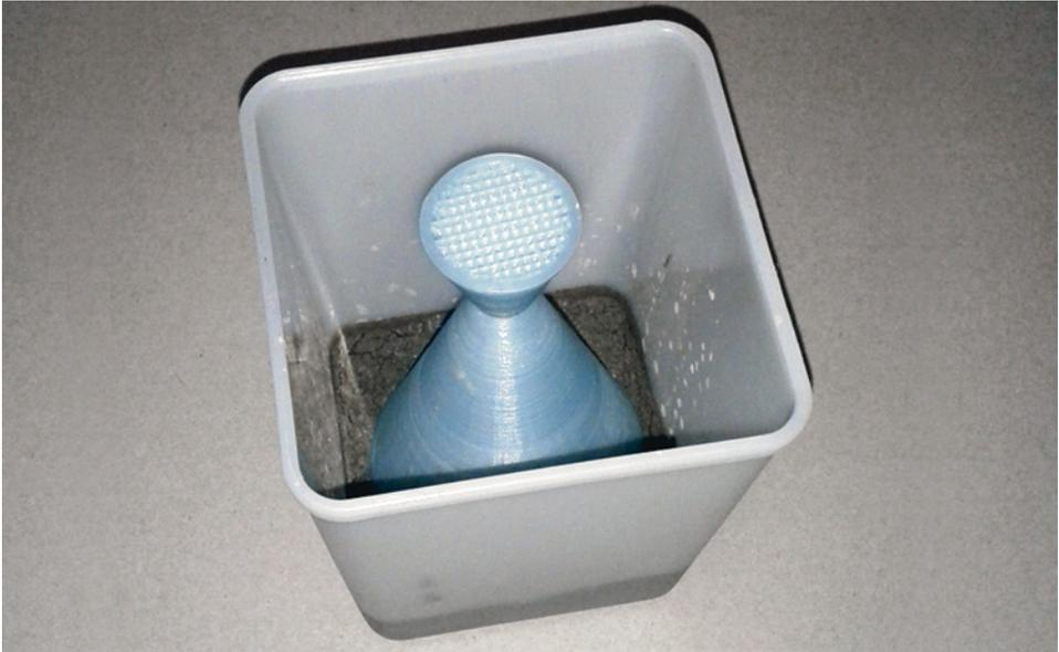
**Bild 3.4** 3D-gedruckte Positivform (hellblau)
