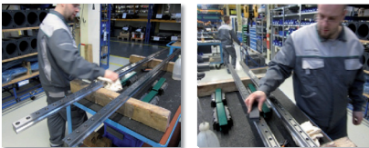
Lagerschuhe abnehmen, Linearführung reinigen und abziehen.
