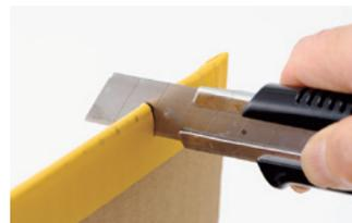
**8** Mit dem Cutter an den markierten Stellen 15 mm tiefe Einschnitte anbringen. Schritt 2–8 bei der anderen Platte wiederholen.
