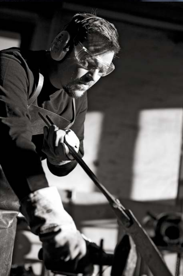
Kursleiter Nandger Franck prüft, ob das Rohling-Stahlstück gerade ist.
