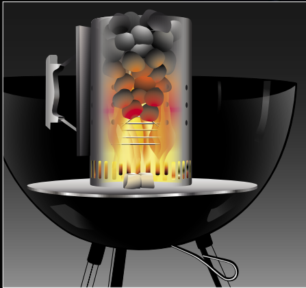
Glut herstellen: Anzündkamin mit Briketts füllen, 2 bis 3 Anzündwürfel (S. 37) auf den Kohlerost legen und anzünden. AZK darüberstellen, nach 25 bis 30 Minuten ist die Glut perfekt.
