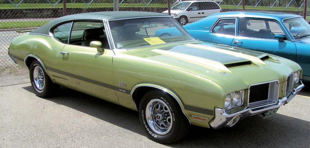
Das Oldsmobile 4-4-2 Coupé – die Zahlen standen für Vierfachvergaser, Vierganggetriebe und Doppelauspuff – ein Klassiker aus der Kategorie Muscle Car, wurde mit Unterbrechungen von 1964 bis 1991 produziert.
