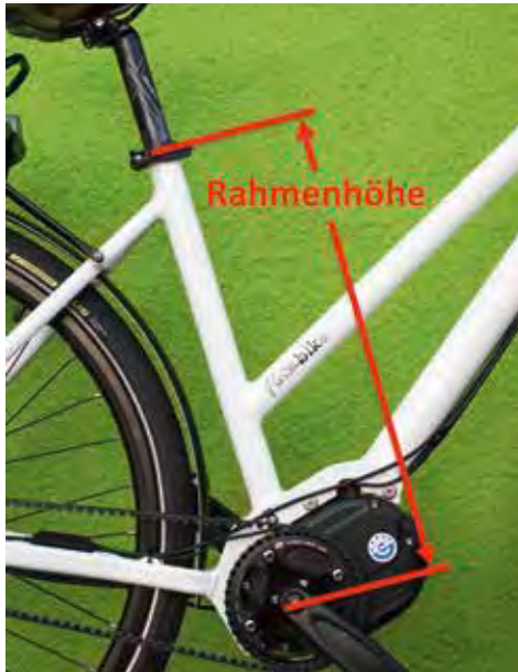
Die Rahmenhöhe wird zwischen Mitte Tretlagerwelle und Oberkante Sitzrohr gemessen.
