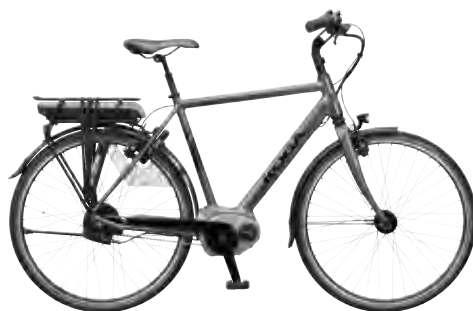
Der Diamantrahmen ist die stabilste Rahmenform.
