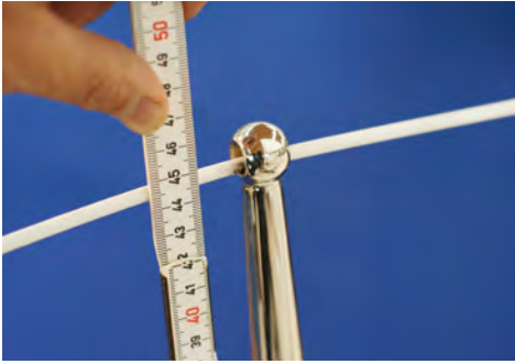
Bis 8,5 Meter Bootslänge und der CE-Norm braucht man eine Reling von 45 Zentimetern Höhe.
