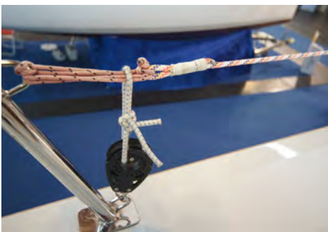
Relingsdrähte müssen nicht mehr zwingend aus Draht und Gewindespannern bestehen. Tauwerk geht auch, muss aber fachkundig ausgesucht sein.
