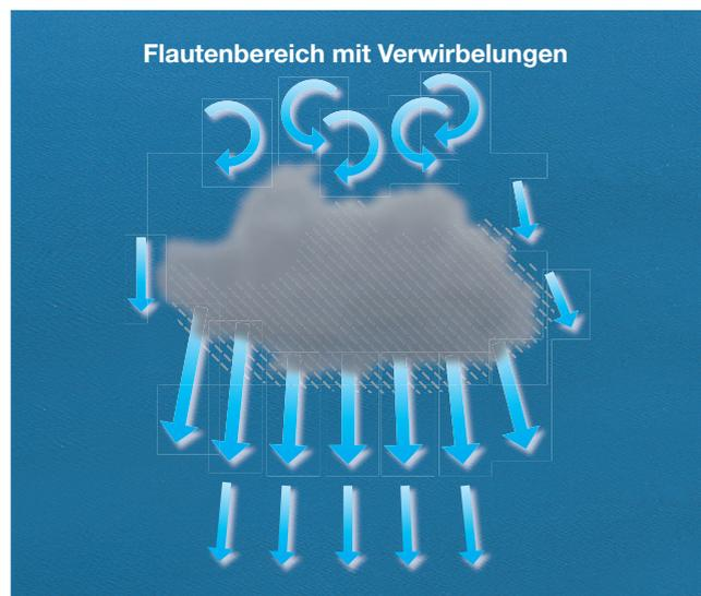
Abb. 3.13 Draufsicht auf die realen Windverhältnisse unter einer Cumuluswolke, aus der Regen austritt
