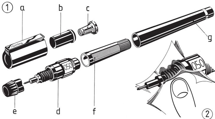
**Bild 1.2-1** Teile des Röhrentuschezeichners (1), Verschlusskappe (a), Einsatz in Verschlusskappe (b), elastische Dichtung (c), Zeichenkegel (d), Abdeckkappe der Tuschewendel (e), Tuschetank (f) und Halterschaft (g). Reinigung der Tuschewendel (2).
