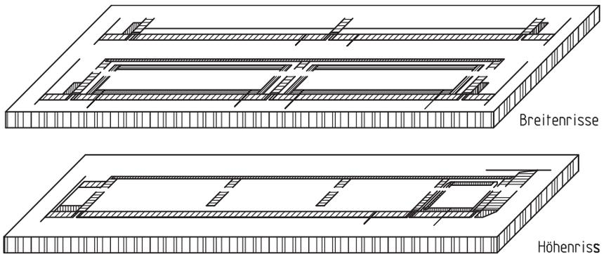
**Bild 1.2-5** Aufriss (Fertigungsriß) mit Breitenriß und Höhenriß
