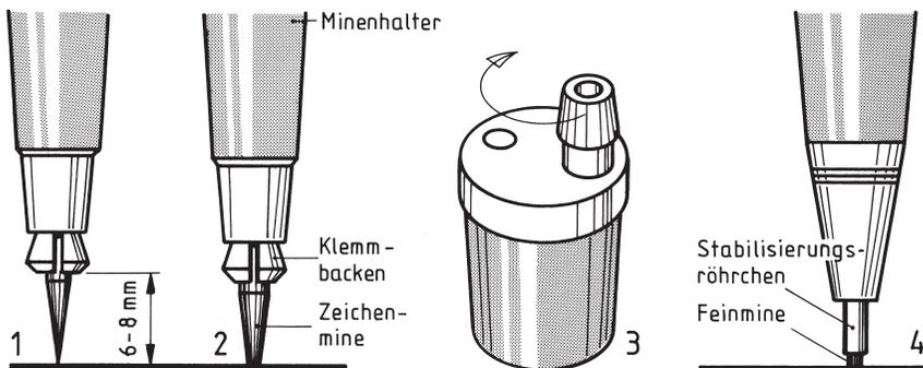
**Bild 1.2-2** Minenzeichengeräte und Spitzer. Fallminenstift mit fein ausgespitzter Zeichenmine zum Zeichnen (1), mit abgestumpfter Zeichenmine zum Beschriften (2), Spitzdose mit Schleifring (3), Feinminenstift (4).
