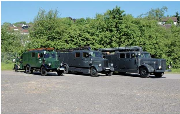
► IFA Phänomen Granit 27, LLG/LF-TS 8, Polygraph Feuerlöschgerätewerk Görlitz, 1948, Traditionsfahrzeug FF Birkenwerder. Eine Reihe von LLG bzw. LF-TS 8 wurde in Ostdeutschland in den ersten Nachkriegsjahren noch nach altem Baumuster produziert.
