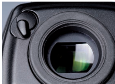
Abbildung 3.9: Licht durch die Sucheröffnung Bei Aufnahmen mit Stativ und Aufnahmen über die Fernbedienung (als separates Zubehör erhältlich) wird das Okular nicht mehr durch das Auge abgedeckt. Die Lichtmesszellen im Prisma fangen das hereinfliegende Licht auf, messen also mehr Licht, als während der Belichtung auf den Sensor fallen wird. Das kann zu einer recht starken Unterbelichtung führen. Die Nikon D600 wird deshalb mit einer Sucherabdeckung geliefert. Haben Sie diese gerade nicht zur Hand, dann können Sie das Okular auch mit der Hand abdecken oder manuell belichten. Die anderen Kameras haben eine eingebaute Okularabdeckung.
