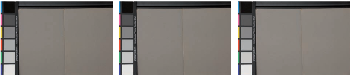
Abbildung 3.7: Die Matrixmessung, die mittenbetonte Messung und die Spotmessung auf eine Graukarte kommen zum gleichen Ergebnis.
