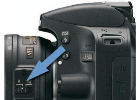
Hat das eingesetzte Objektiv keinen solchen Schalter, kann der Entfernungseinstellung des Objektivs nur verwendet werden, wenn in den Aufnahmeinformationen die manuelle Fokussierung (*MF*) eingestellt wurde.
