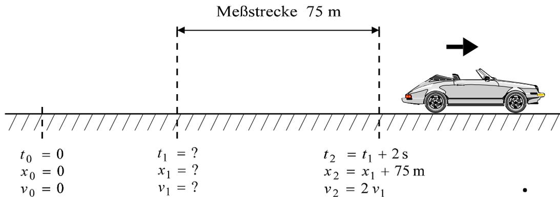
**Abb. 2.7–1** Der beschleunigte Rennwagen durchfährt eine Mess-Strecke mit den angeführten Daten.
