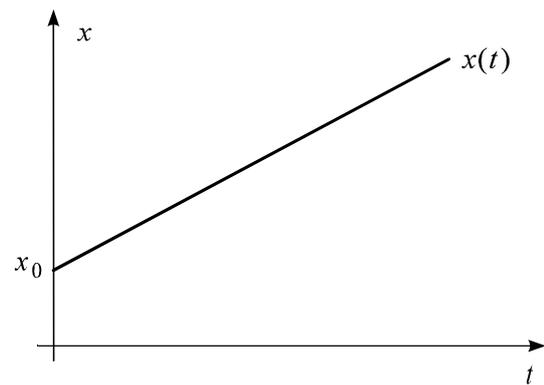
Abb. 2.2–1 Orts-Zeit-Diagramm einer gleichförmigen Bewegung
