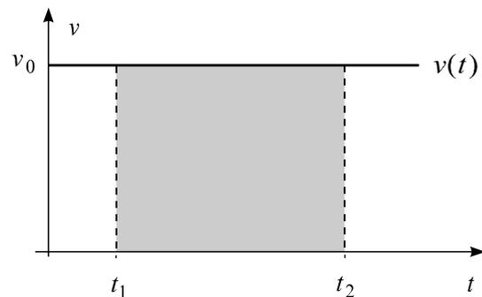
**Abb. 2.3–1** Die graue Fläche im Geschwindigkeits-Zeit-Diagramm ist gleich dem zurückgelegten Weg.
