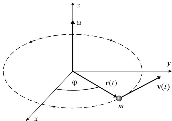
Abb. 2.5-2 Die Winkelgeschwindigkeit  $\vec{\omega}$  steht senkrecht auf der Kreisbahn und fällt daher mit der Drehachse zusammen.
