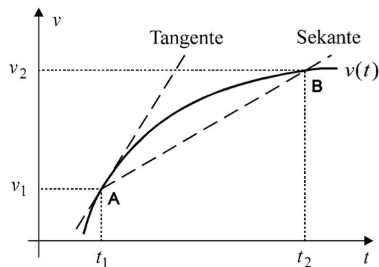
**Abb. 2.4–1** Die Steigungen der Sekante und Tangente im Geschwindigkeits-Zeit-Diagramm sind laut Definition die mittlere und die momentane Beschleunigung.
