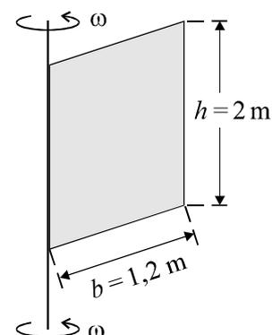
**Abb. 2.7–3** Das *dünne* Brett ist an eine rotierende Achse angeklebt.
