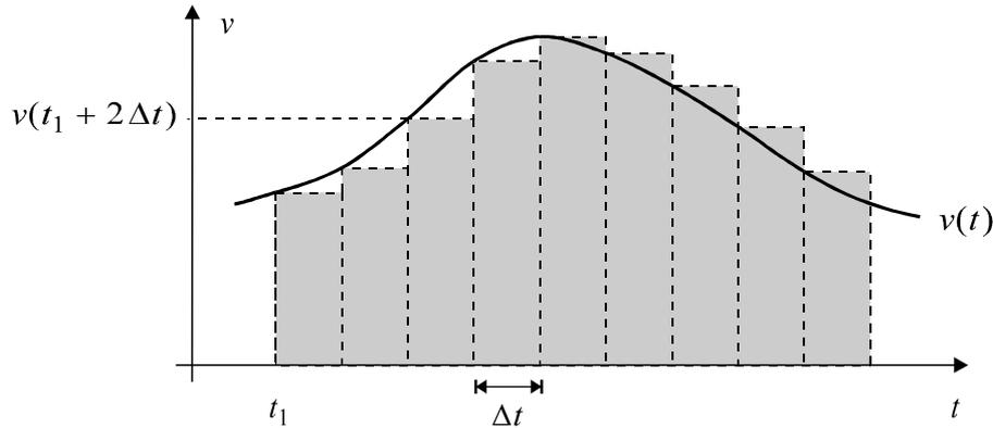
**Abb. 2.3–2** Der gesamte zurückgelegte Weg ist die Summe der in den Teilintervallen zurückgelegten Teilwege. Für kleine  $\Delta t$  ist jeder Teilweg ungefähr gleich der Geschwindigkeit am Anfang des Teilweges mal  $\Delta t$ .
