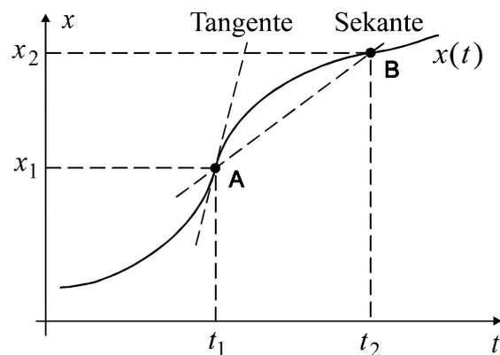
Abb. 2.2–2 Für  $t_2 \rightarrow t_1$  geht die Steigung der Sekante über in die Steigung der Tangente. Die Steigung der Tangente ist laut Definition die momentane Geschwindigkeit  $v(t_1)$ .
