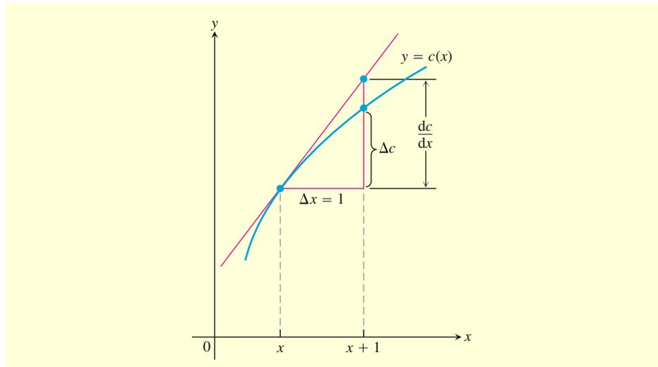
**Abbildung 3.12** Die Grenzkosten  $dc/dx$  sind näherungsweise die zusätzlichen Kosten  $\Delta c$  für die Produktion von  $\Delta x = 1$  weiteren Einheiten.
