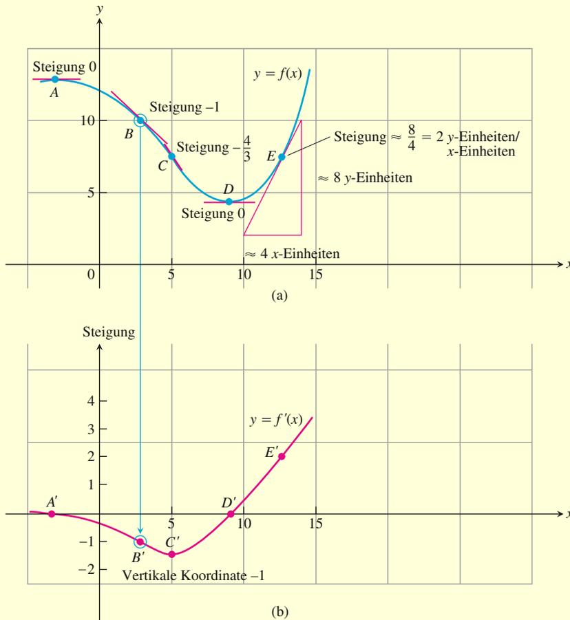
**Abbildung 3.4** Wir haben den Graphen von  $y = f'(x)$  in Teil (b) konstruiert, indem wir die Steigungen des Graphen von  $y = f(x)$  aus Teil (a) aufgetragen haben. Die y-Koordinate von  $B'$  ist die Steigung im Punkt  $B$  usw. Teil (b) entnehmen wir, dass die Steigung von  $f$  für  $x$  zwischen  $A'$  und  $D'$  negativ ist; rechts von  $D'$  ist sie positiv.
