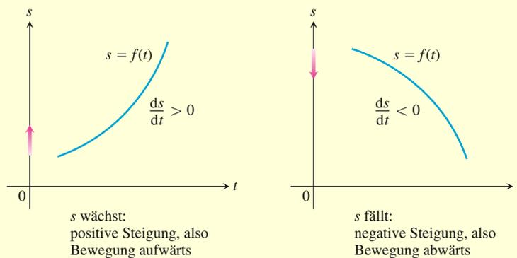
**Abbildung 3.10** Bei einer geradlinigen Bewegung  $s = f(t)$  (entlang der vertikalen Achse) ist  $v = ds/dt$  für wachsendes  $s$  positiv und für fallendes  $s$  negativ. Die blaue Kurve zeigt den Ort über der Zeit; sie gibt nicht die auf der  $s$ -Achse liegende Bahnkurve wieder.
