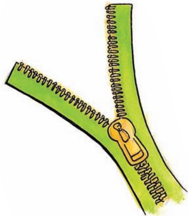
Ein Reißverschluss hat zwei Seitenteile mit kleinen Zähnen. Mit einem Schieber kannst du die Zähne ineinander verhaken und wieder lösen.
