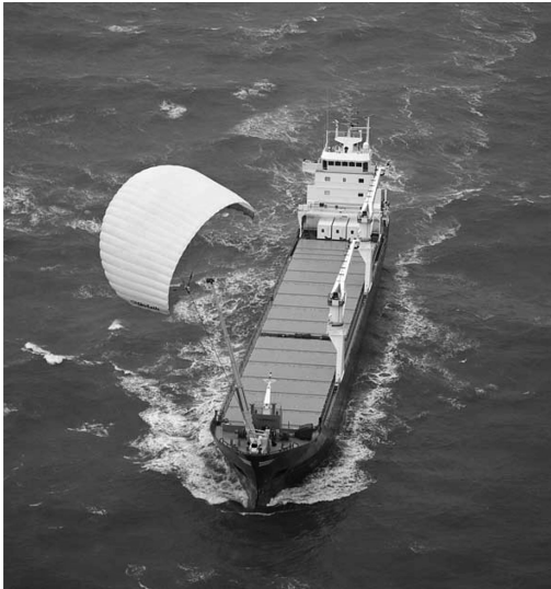
Abb. 1.7 Drachenantrieb für Handelsschiffe der Firma Skysails (Foto © Skysails, mit freundlicher Genehmigung).
