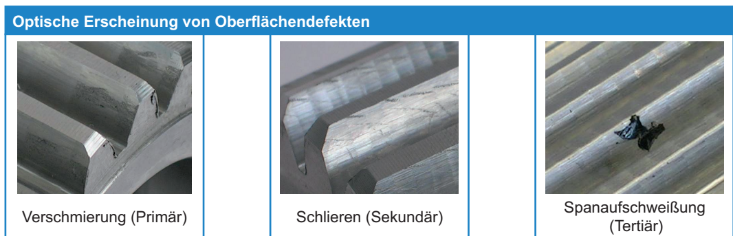
Bild 4.29 Oberflächendefekte auf Zahnflanken [STUC14]
