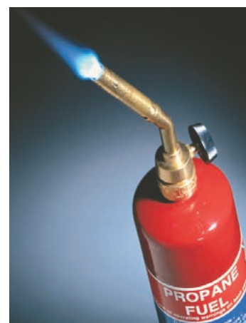
Abbildung 3.7: An Luft verbrennendes Propan. Das flüssige Propan, \text{C}_3\text{H}_8 , verdampft und vermischt sich beim Austreten aus der Düse mit Luft. Bei der Verbrennungsreaktion von \text{C}_3\text{H}_8 und \text{O}_2 entsteht eine blaue Flamme.
