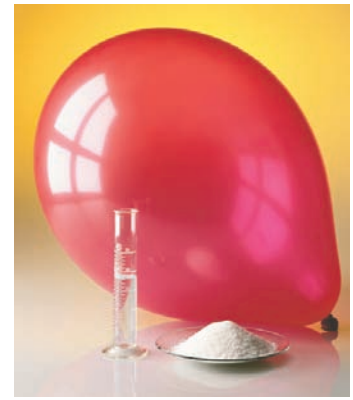
Abbildung 3.9: Ein Mol eines Festkörpers, einer Flüssigkeit und eines Gases. Ein Mol des Festkörpers NaCl hat eine Masse von 58,45 g. Ein Mol H 2 O, der Flüssigkeit, hat eine Masse von 18,0 g und nimmt ein Volumen von 18,0 ml ein. Ein Mol des Gases O 2 hat eine Masse von 32,0 g und füllt einen Luftballon, dessen Durchmesser 35 cm beträgt.
