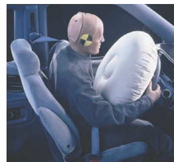
Abbildung 3.6: Airbag eines Autos. Der Zerfall von Natriumazid, \text{NaN}_3(\text{s}) , wird zum Aufblasen von Airbags verwendet. \text{NaN}_3 zerfällt nach der Zündung schnell unter Bildung von gasförmigem Stickstoff, \text{N}_2(\text{g}) , der den Airbag füllt.
