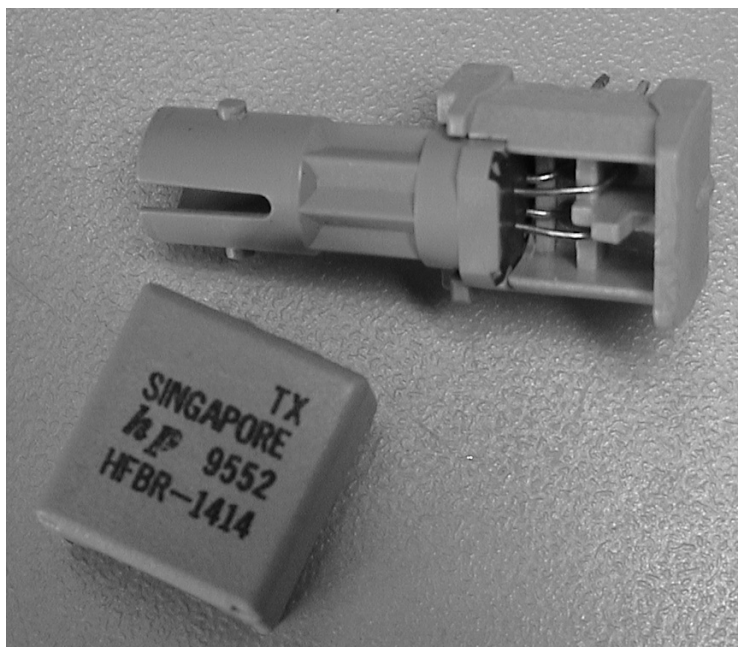
Abbildung 3.31: Der Transmitter von HP verfügt neben der LED für die Datenübertragung über eine zweite für die LAN-Verbindungskontrolle, was anhand der vier (statt zwei) Anschlüsse im Gehäuse zu erkennen ist.
