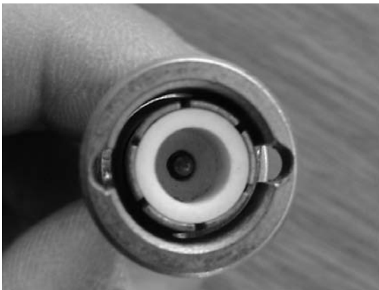
Abbildung 3.3: Der Kontaktstift in der Mitte des BNC-Steckers liegt zu weit hinten, was für Kontaktprobleme verantwortlich ist.
