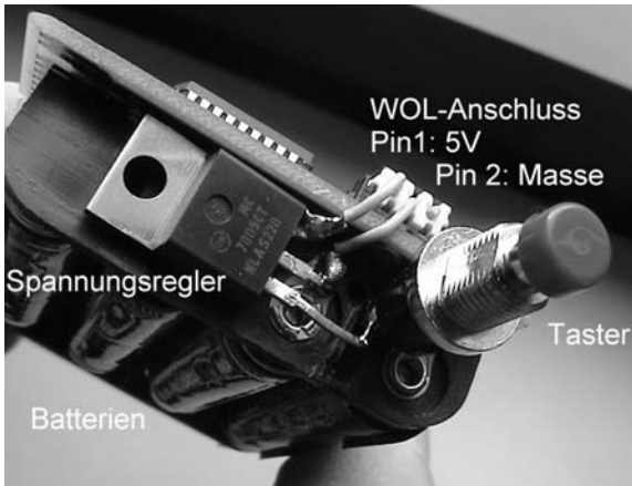
Abbildung 3.21: Die Zusatzschaltung für die Netzwerkkarte im Detail
