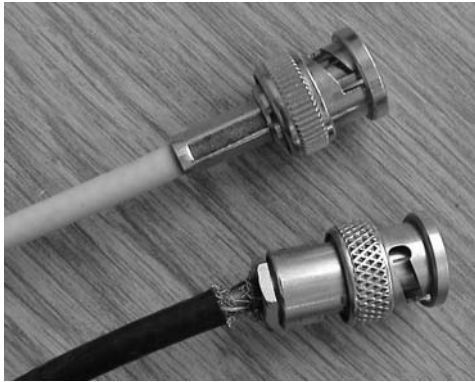
Abbildung 3.1: Oben ein fertig gekauftes Koaxialkabel mit aufgequetschter Verbindung und unten ein selbst angefertigtes, das nach mehrmaligem Stecken aufgrund einer mangelhaften Konfektionierung aus dem Stecker rutscht und keine elektrische Verbindung mehr herstellen kann.
