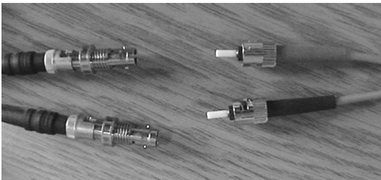
Abbildung 3.24: LWL-Strecken lassen sich mithilfe von Kupplungsstücken problemlos verlängern.
