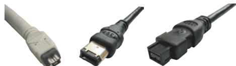
FireWire-Anschlussstecker: FireWire 400 (4-polig), FireWire 400 (6-polig) und FireWire 800
