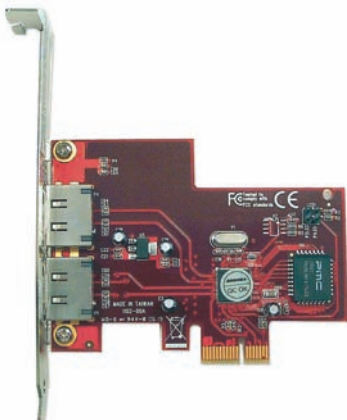
PCI- Express-x1- Karte (1 Lane) mit zwei eSATA- Schnittstellen
