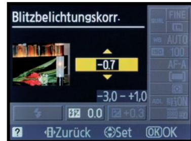
Die Abbildung zeigt das Einstellmenü einer Digitalkamera, in dem man die Blitzleistung nach oben oder unten korrigieren kann.
