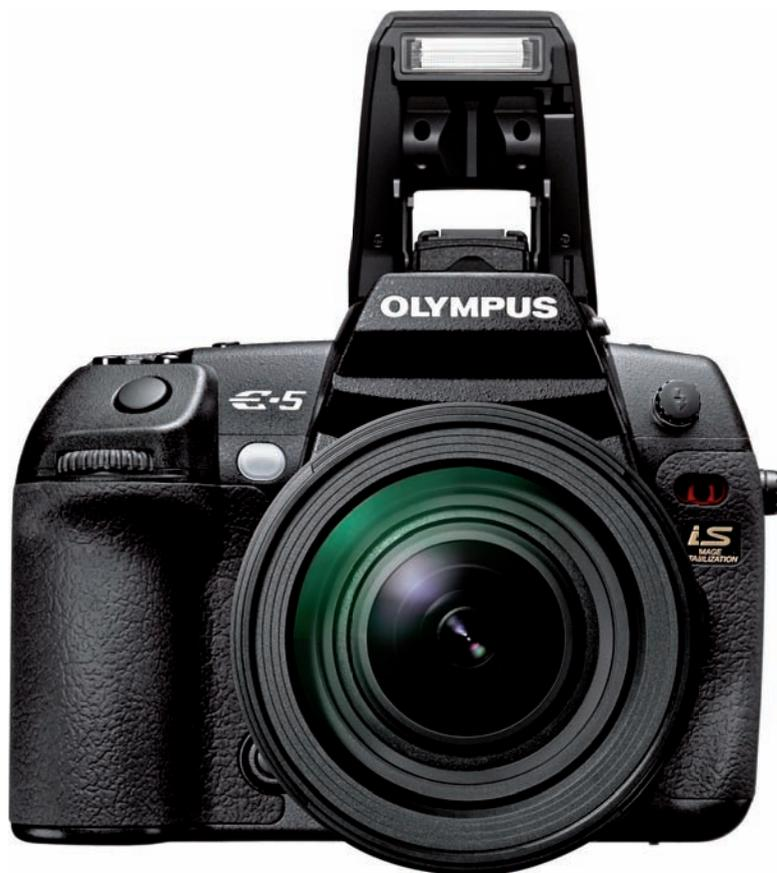
*Je höher ein Aufklappblitz aus dem Kameragehäuse wie bei dieser Olympus E-5 herausklappt, desto geringer ist die Gefahr des gefürchteten Rote-Augen-Effekts. Außerdem ist der Blitz dann besser für Nahaufnahmen geeignet, da das Objektiv keine ungewollten Schatten verursacht.*
