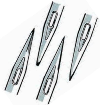
**Wichtig:** Nur Nadeln mit einwandfreier Spitze verwenden. Eine defekte Nadel beschädigt den Stoff. Zur Kontrolle in eine dünne Strumpfhose stechen. Wenn die Nadel beim Ein- und Ausstechen hängen bleibt, ist sie defekt und sollte ausgetauscht werden.
