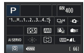
Im Menü wird die Korrektur auch angezeigt, allerdings verschiebt sich im Gegensatz zu Vorgängermodellen die Skala und nicht das kleine anzeigende Viereck unterhalb der Skala.
