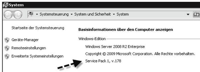
Abbildung 3.4: Anzeigen des installierten Service Packs in Windows Server 2008 R2
