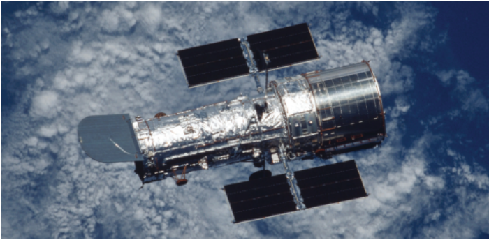
Abb. 3: Im Jahr 1990 wurde das Hubble Space Telescope (HST) in eine erdnahe Umlaufbahn außerhalb der Erdatmosphäre gebracht. Seine volle Leistung erreichte es jedoch erst 1993, nachdem man in einer Reparaturmission die Abbildungsfehler des Hauptspiegels mit einer Korrekturlinse beseitigt hatte. Seitdem liefert das HST immer wieder spektakuläre Bilder aus den Tiefen des Kosmos.
