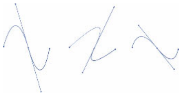
Abbildung 3.10 Die Länge und der Winkel der Richtungslinie bestimmt das Aussehen der zugehörigen Segmente.
