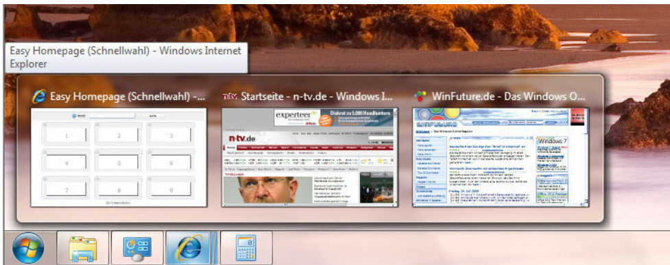
Abbildung 3.8 Windows zeigt eine Vorschau an, wenn Sie mit der Maus in der Taskleiste auf das Symbol eines geöffneten Programms zeigen.
